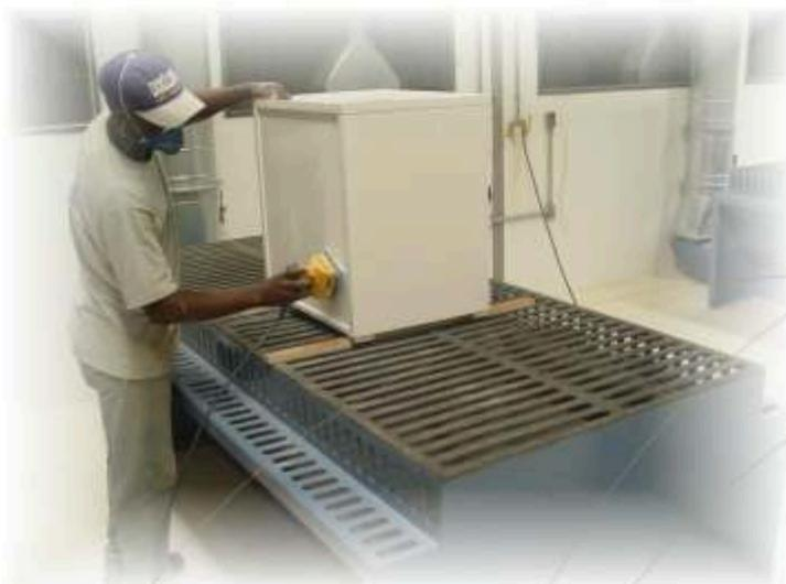
Fabricamos mesas de lixação, para conexão a sistemas centrais de aspiração e retenção, nos mais variados dimensionais, sendo cada projeto conduzido de modo a satisfazer plenamente as necessidades de cada cliente.
